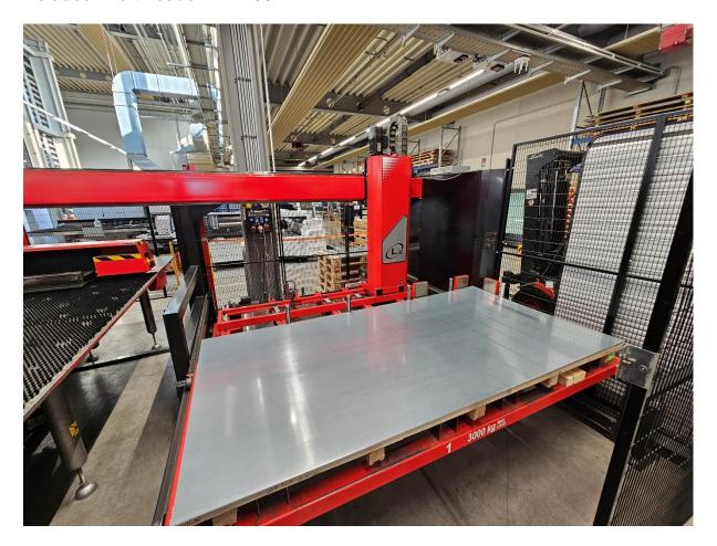
Blechabmessung min.: 700 x 300 mm Blechabmessung max.: 2500 x 1250 mm
